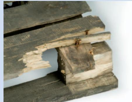
Mehr als zwei Boden- oder Deckrandbretter sind so abgesplittert, dass mehr als ein Nagel- oder Schraubenschaft sichtbar ist.
