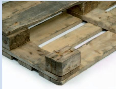
Ein Boden- oder Deckrandbrett ist so abgesplittert, dass mehr als ein Nagel- oder Schraubenschaft sichtbar ist.
