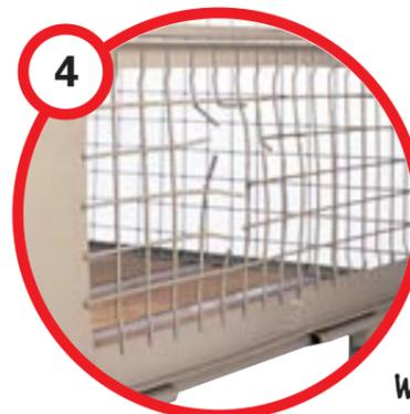
Die Rundstahlgitter sind gerissen, so daß die Drahtenden nach innen oder außen ragen (eine Masche pro Wand darf fehlen)
