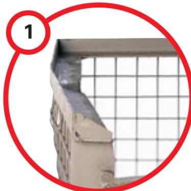
Der Steilwinkelaufsatz oder die Ecksäulen sind verformt
