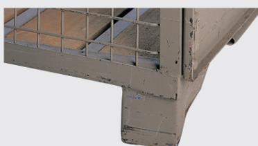
Der Bodenrahmen oder die Füße sind so verbogen, dass die Gitterboxpalette nicht mehr gleichmäßig auf vier Füßen steht oder nicht mehr ohne Gefahr gestapelt werden kann.
